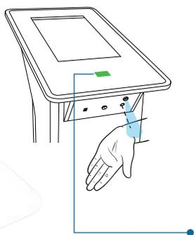
**ASPIS** è un'Apparecchiatura in grado di misurare/rilevare la Temperatura Corporea e di erogare Disinfettante o Igienizzante a base idroalcolica specifico per le mani.
